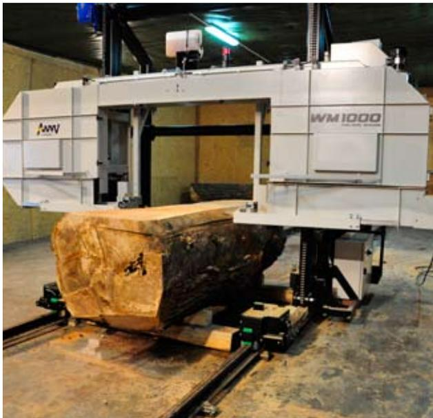
Пилящая голова WM1000 движется по рельсам, которые должны быть стабильно и прочно закреплены в фундаменте. Станок WM1000 может быть использован в следующих конфигурациях:
